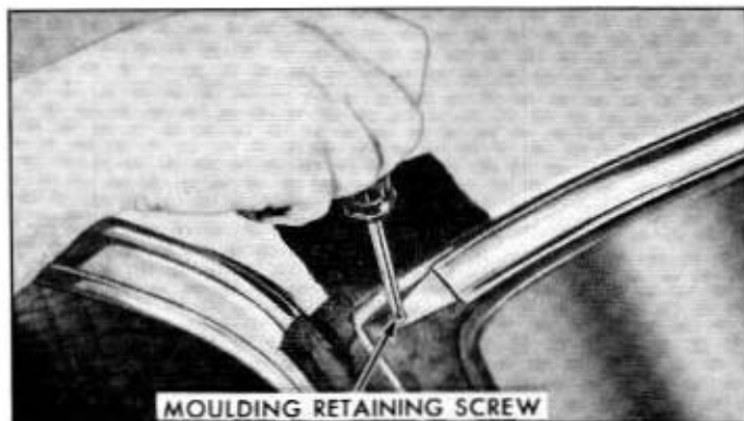
Fig. 13C-2—Windshield Top Moulding—(60C-8041)
