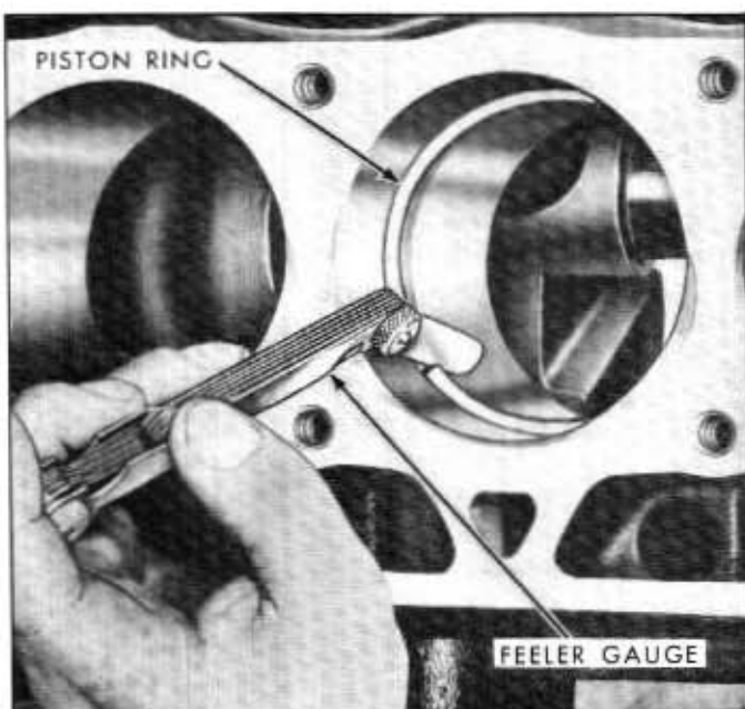
Fig. 6A-44—Measuring Piston Ring End Gap—(60C-5643)
